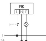
La lumière peut être allumée manuellement en fonction des besoins grâce à la commande à pousoir. La lumière s'éteint automatiquement quand la minuterie expire.
