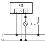
Permet l'allumage manuel de l'éclairage raccordé. Attention: la lumière doit ensuite être éteinte manuellement.
