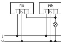
Ne jamais brancher plus de 5 détecteurs de mouvement en parallèle. En cas de nombre plus élevé, il peut se produire des commutations intempestives à cause de l'étendue respectivement de la clarté réduite de la zone de détection.
