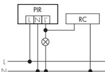
Lors du branchement d'inductances parallèles au réseau (lampes fluorescentes, contacteurs, etc.), un circuit RC peut être nécessaire.
